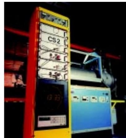
Die primäre Atomuhr CS2 der PTB, mit der zz. UTC(PTB) realisiert wird
